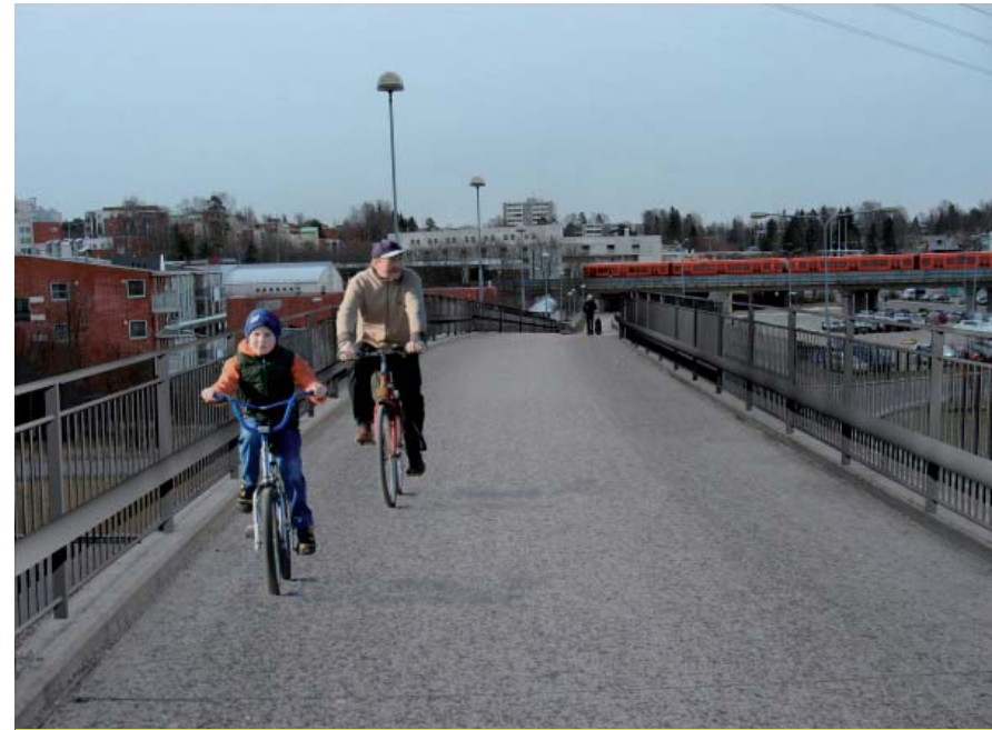
Kuva 11. Havainnekuva aurausjohteen käytöstä kevyen liikenteen sillalla yhdistettynä pystypinnoilla varustettuun suojakaiteeseen.
